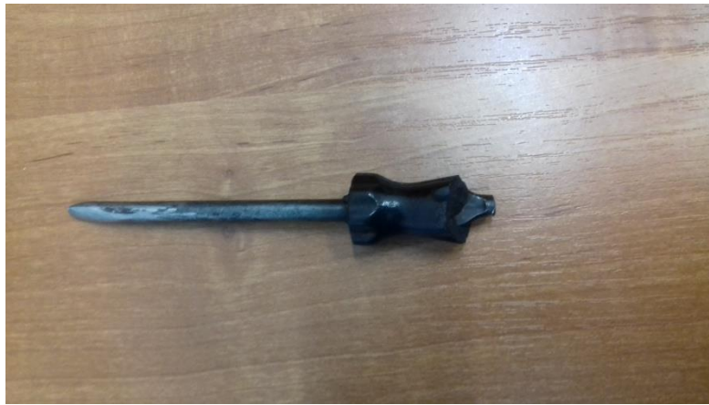
Рисунок 10 – Использовать такую отвертку не безопасно Качественный инструмент – качественно выполненная работа.
