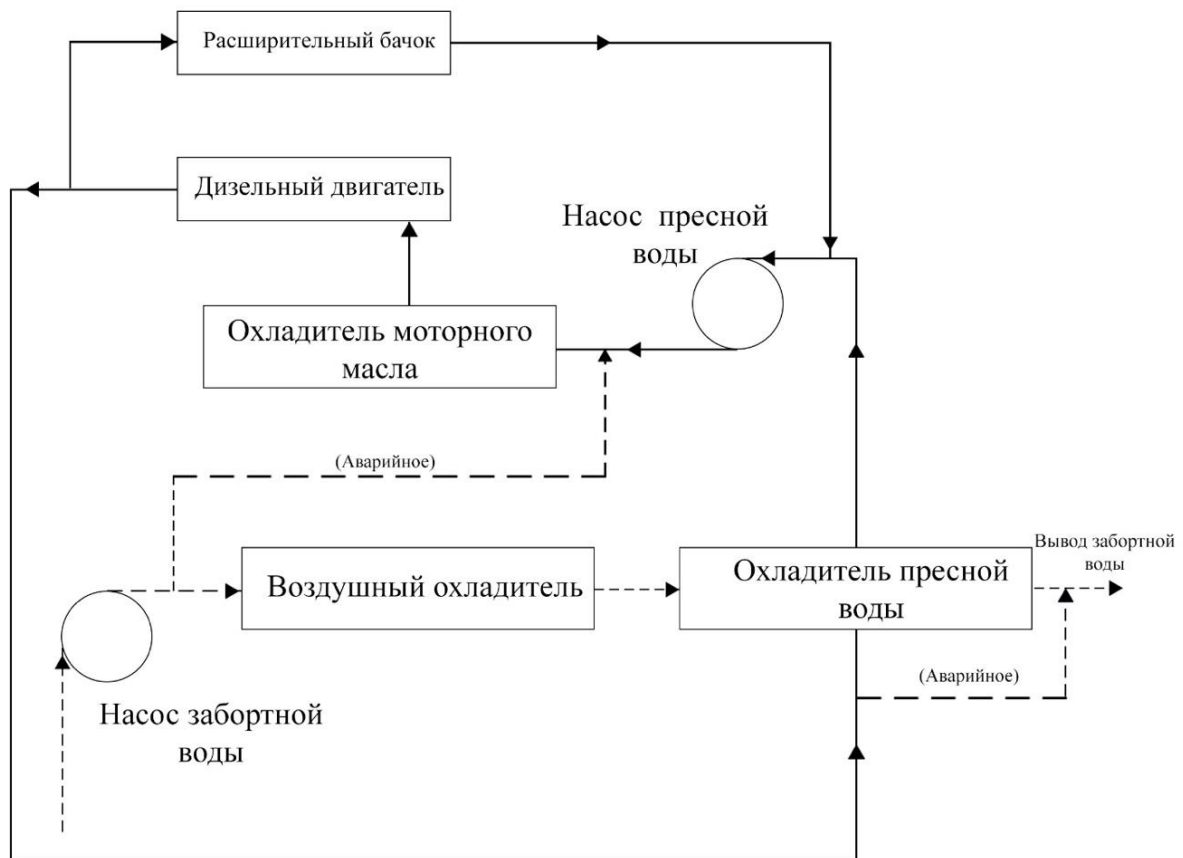
Рис. 1. Система охлаждения двигателя «Чидонг» серии 6190
